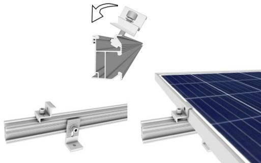
Continuamos con el siguiente panel pero esta vez utiliza los Inter Clamp. Repite la operación hasta que llegues al último panel de la fila, terminaremos otra vez con los End Clamp, como empezamos a sujetar el primero.
